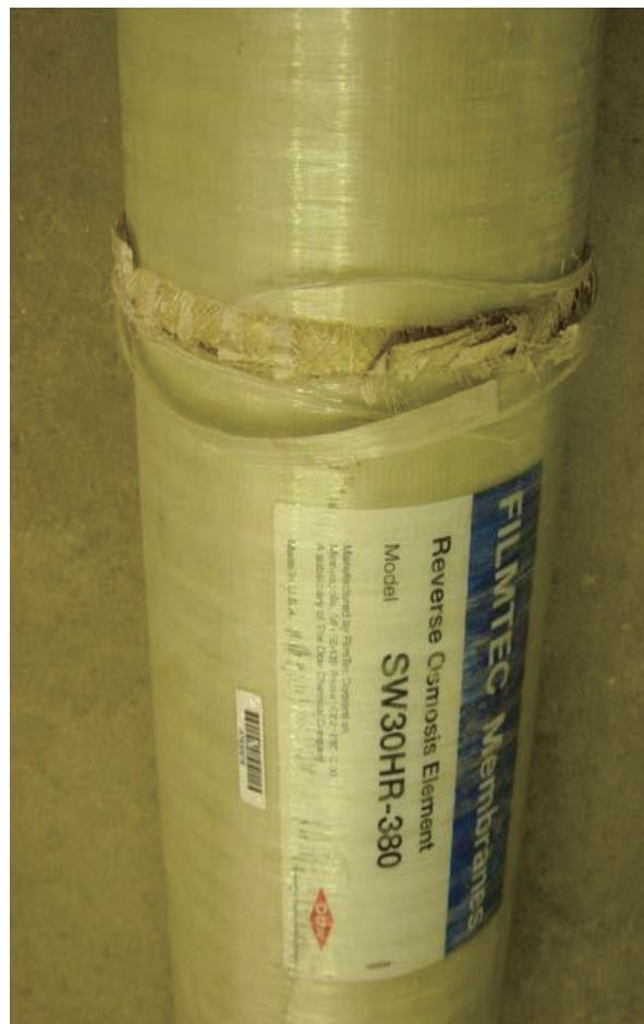
9-9 膜表面缠绕玻璃钢高压差破裂
