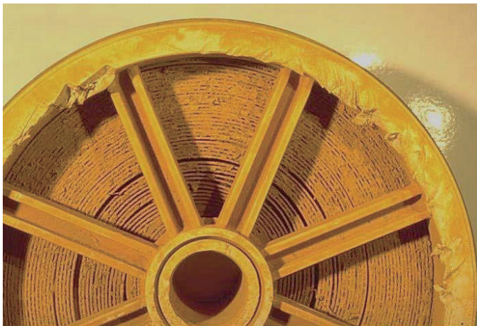
图 9-5 膜元件进水端铁污染（伴随轴向机械力所致膜卷错位损坏）
